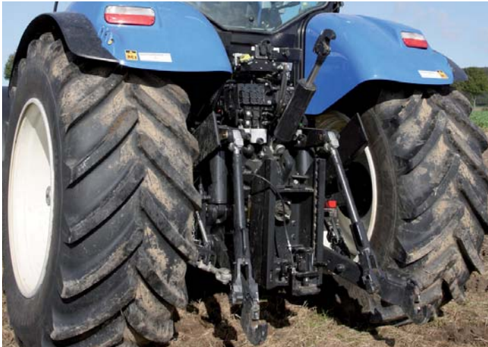
Das Hubwerk hebt viel, aber die Geometrie könnte eine Überarbeitung gut vertragen. Die Hydraulik-Ausstattung und -Leistung ist super.
