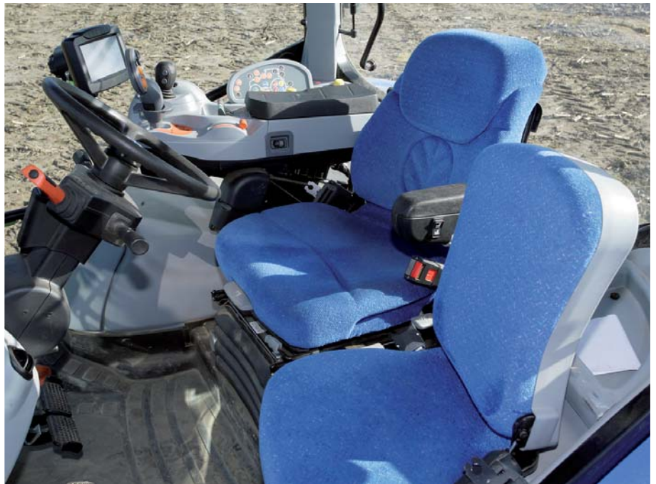
Guter Arbeitsplatz, aber die von New Holland versprochenen 69 dB(A) unter Last hat das DLG-Testzentrum mit gemessenen 76,1 dB(A) deutlich übertroffen.
