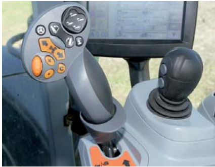
Der Fahrhebel ähnelt dem der FR-Häcksler und bietet viele Funktionen.
