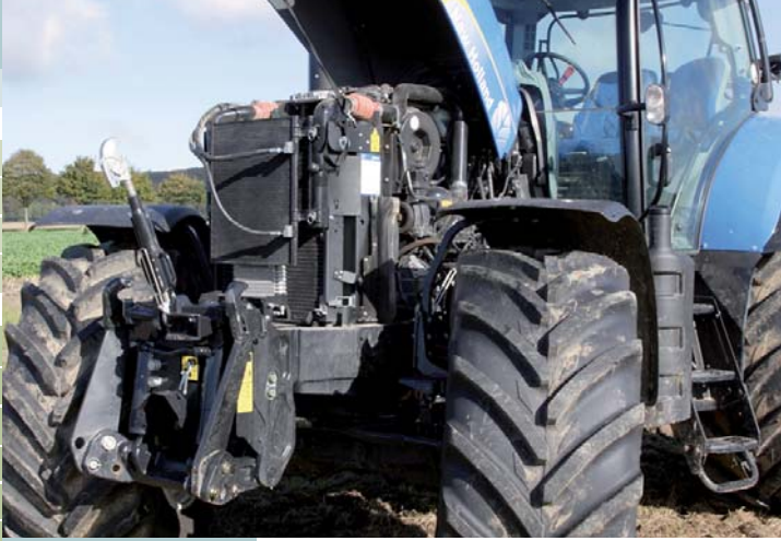
Nur ein „kleiner“ Boost, aber durchaus sparsam: Der NEF-Motor mit 6,7 l Hubraum.
