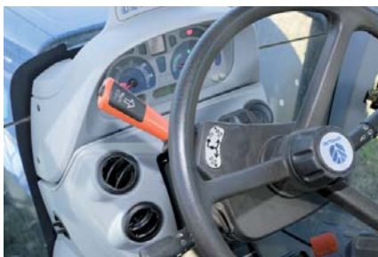
Die Wendeschaltung wird links unterm Lenkrad oder im Fahrhebel betätigt – prima!
