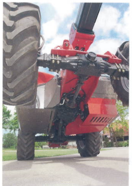
Ein geschlossenes Bodenblech zum Schutz der Antriebsaggregate gibt es beim MLT 735 nur als Wunschausstattung.
