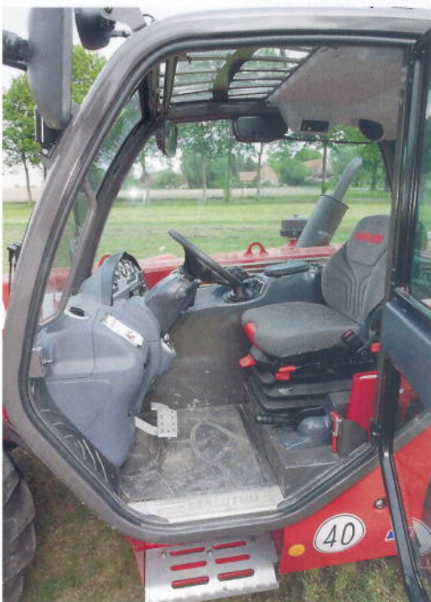
Neben dem Einstieg und der Kabinenbreite fiel uns der Joystick des MLT äußerst positiv auf (Bild oben rechts). Nicht gut ist dagegen der davor angeordnete Hebel samt Arretierung für die Lenkartwahl.
