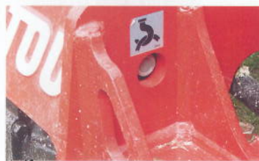
Die Werkzeugaufnahme macht einen stabilen Eindruck (Bild oben). Die serienmäßige Verriegelung mit einer Stange ist auch dank der Parkposition in Ordnung (rechts oben). Spitze ist der Taster über der Vorderachsaufnahme, um die Hydraulik drucklos zu schalten (rechts unten).
