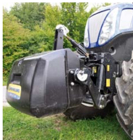
Die integrierte Fronthydraulik mit Fernbedienung hebt maximal 3.785 kg. Ein doppeltwirkendes Hydraulikventil vorn ist möglich.
